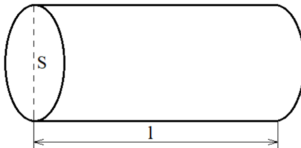
Рисунок 2.1 – Пример модели протекания воздуха через ветроколесо
