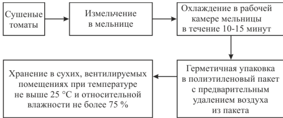
Рисунок 3.26 – Последовательность операций по получению томатного порошка и условия его хранения
