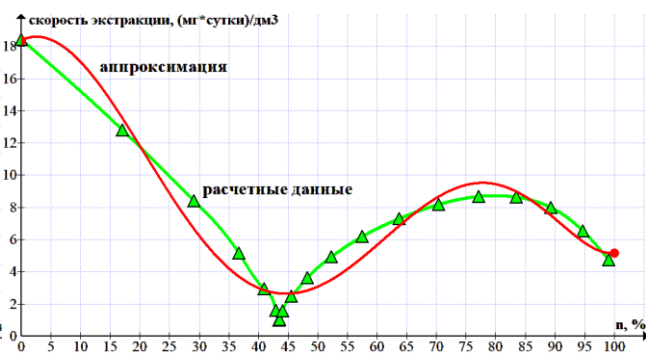
Рисунок 8 – Расчетная и аппроксимированная зависимости \frac{dC_x}{dT} = f(n) для ВД крепостью 60 % об.
