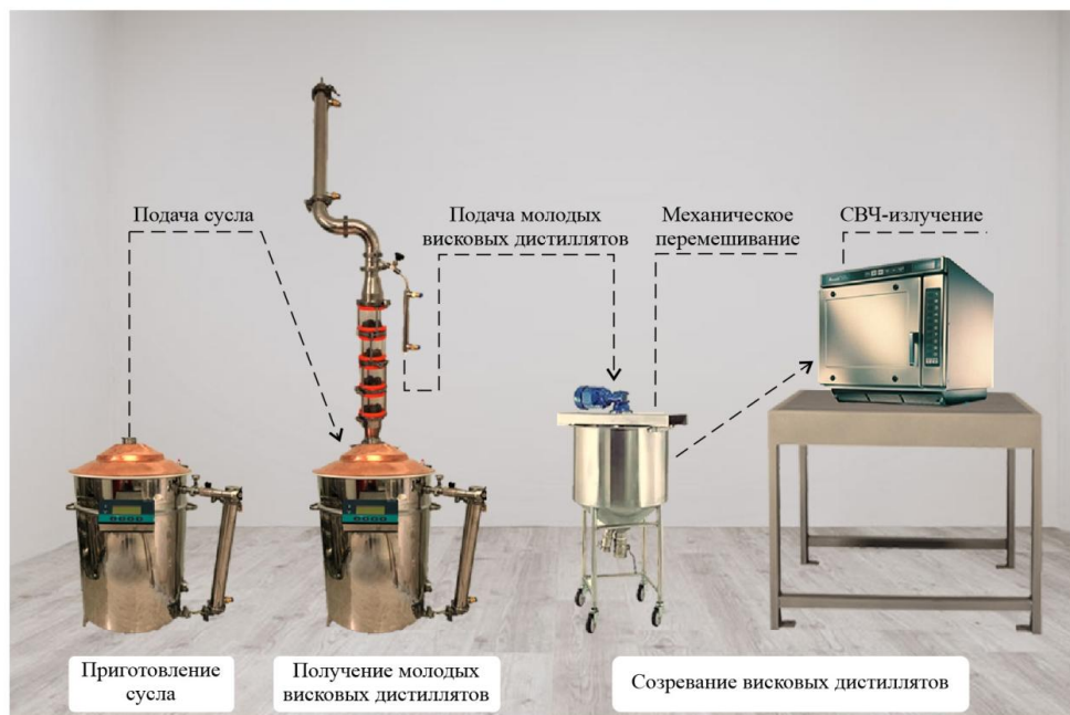
Рисунок 9 – Технологическая линия производства выдержанных висковых дистиллятов
