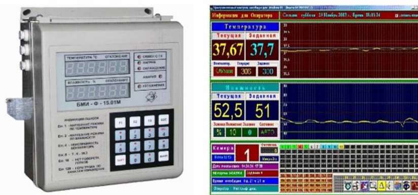
Рисунок 1.2 - Система контроля и автоматизации
